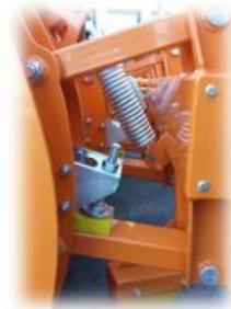
Insert polyuréthane Contre les vibrations
