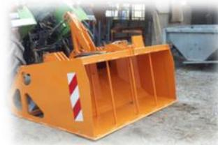
**Basculement de la trémie en godet chargeur**
